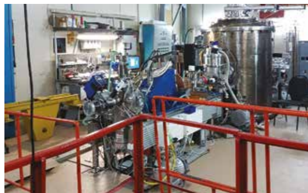
Ускорительный источник нейтронов для БНЗТ – методики лечения рака. Источник: пресс-служба ИЯФ СО РАН.
