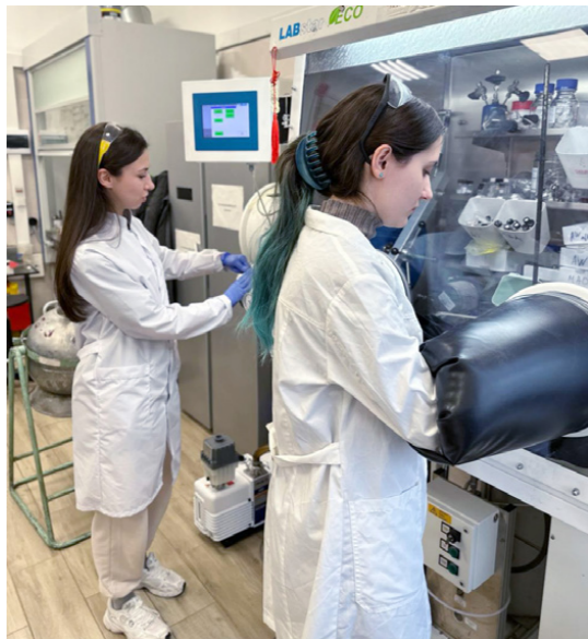
Работа в главбоксе с нестабильными на воздухе веществами в инертной среде. Источник: Евгения Бермешева
