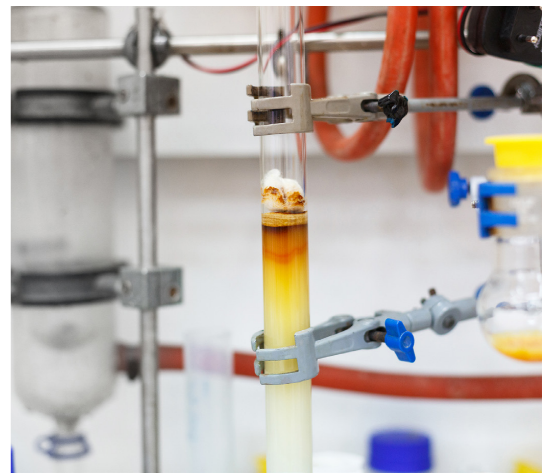
Колоночная хроматография, необходимая в анализе органических соединений
