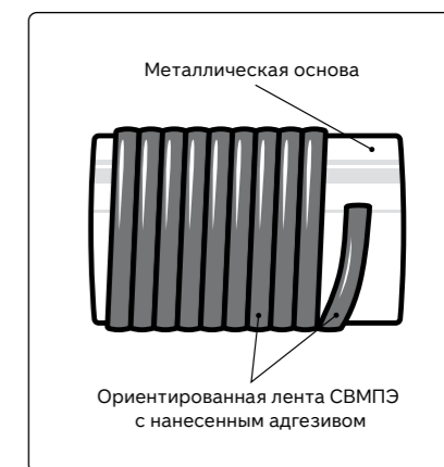
Ориентированная лента сверхвысокомолекулярного полиэтилена с адгезивом на металлическом цилиндре
