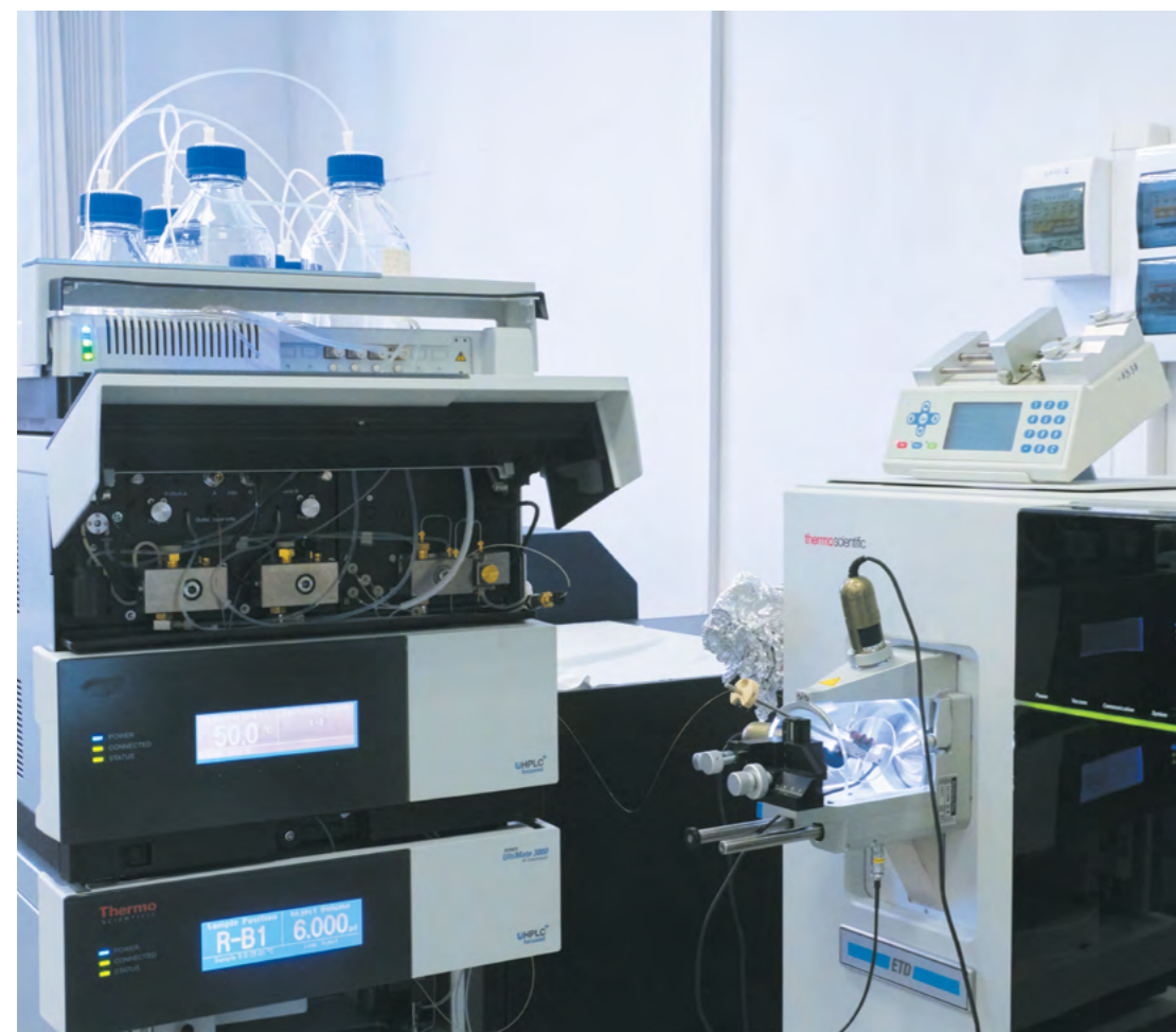
Система двумерной газовой хроматографии — времяпролетной масс-спектрометрии Pegasus 4D GC/GC-TOF MS, LECO. Источник: Петр Куценюг
