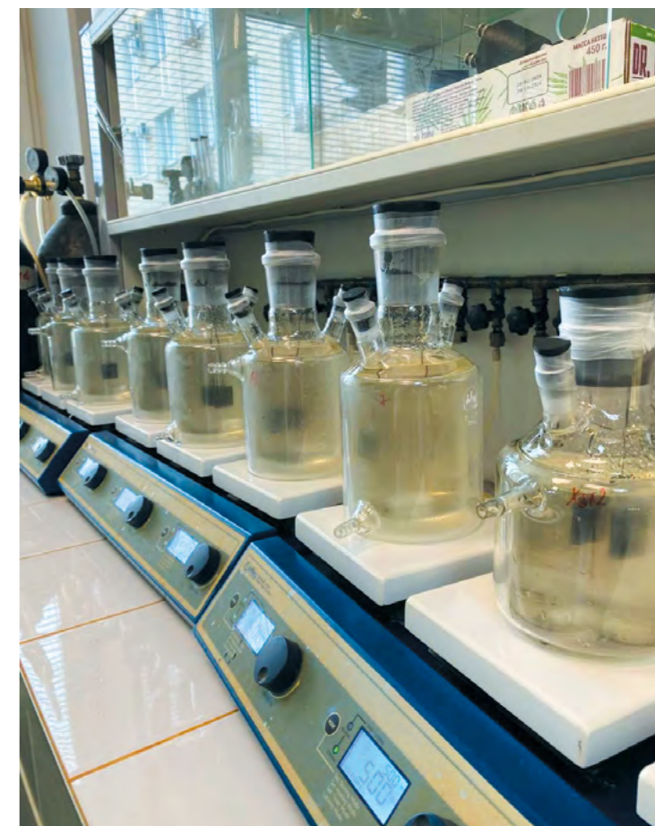
Установка для оценки защитной способности ингибиторов коррозии гравиметрическим методом. Источник: Гульнара Гайнанова
